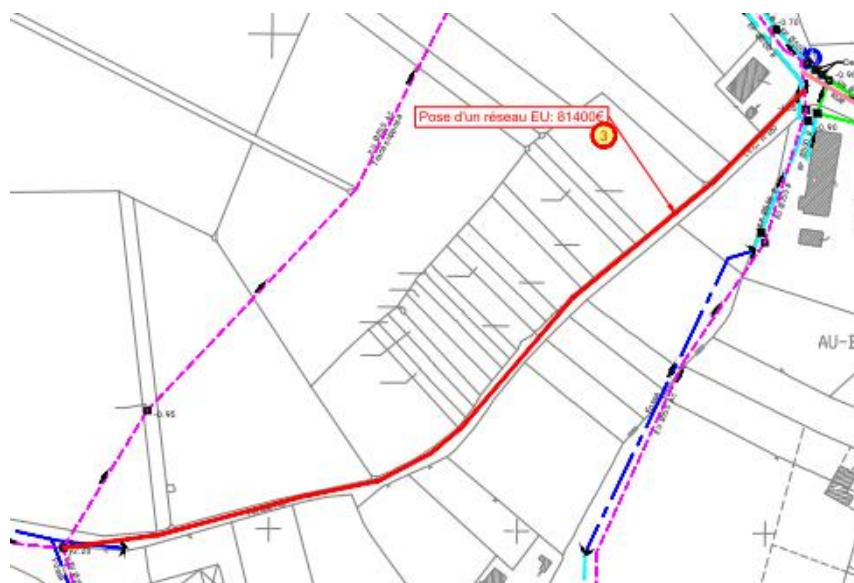
Pose d'un collecteur eaux usées
