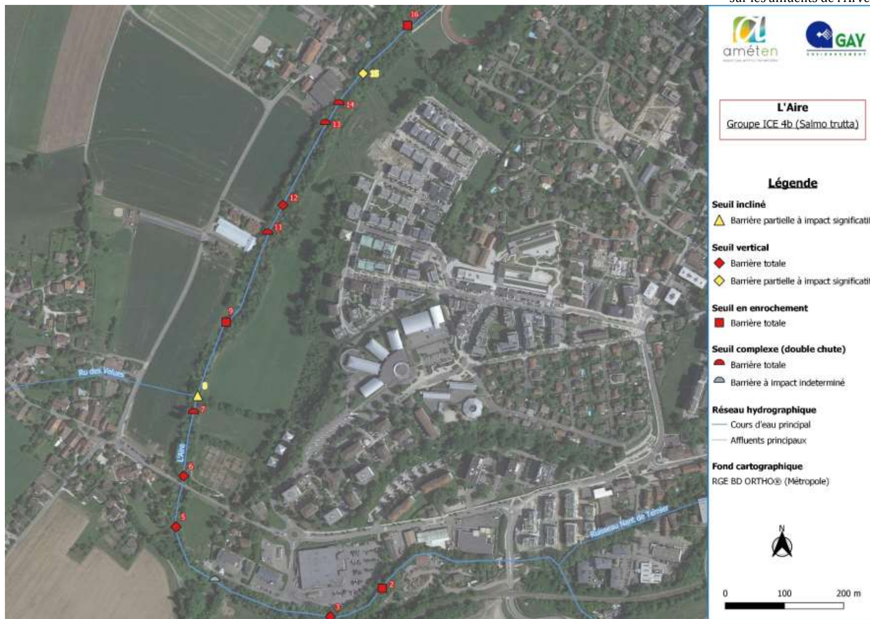
Figure 15 : Cartographie des ouvrages sur l'Aire et classes de franchissement ICE associées – Source : Améten/Gay environnement 2022
