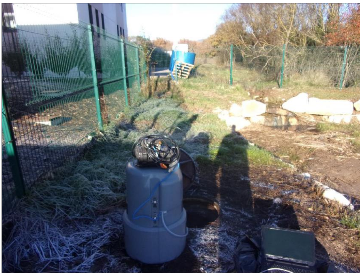
Figure 5 : Regard de prélèvement et préleveur 24 flacons – FRAGWORLD
