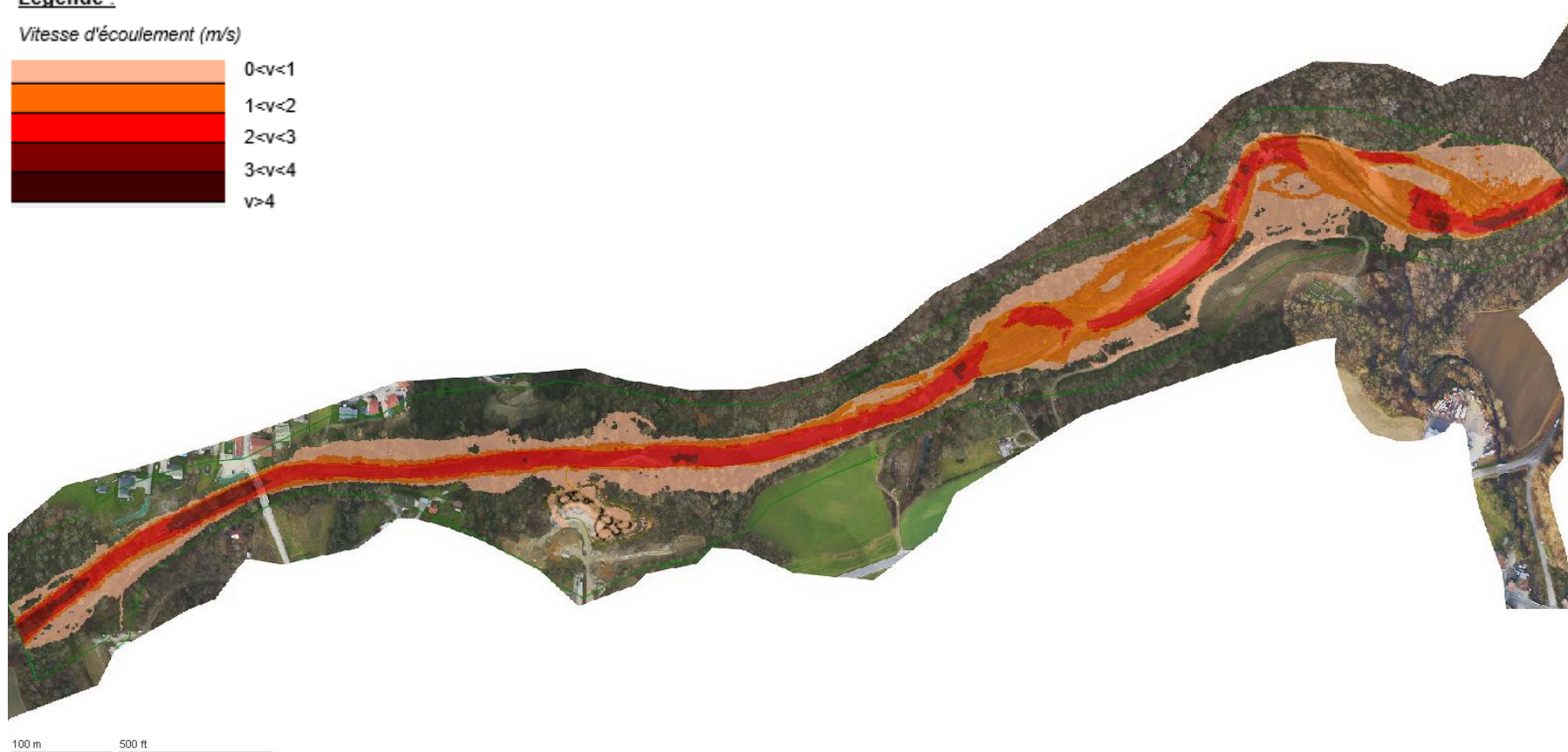
Figure 33 : Cartographie des vitesses d'écoulement maximales dans l'état projet pour le débit de pointe décennal Q10
