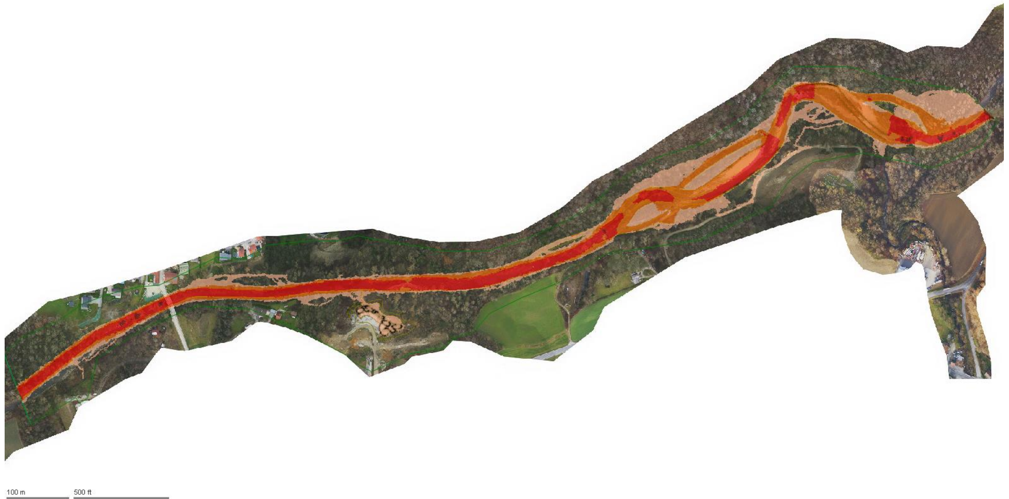
Figure 31: Cartographie des vitesses d'écoulement maximales dans l'état projet pour le débit de pointe biennal Q2
