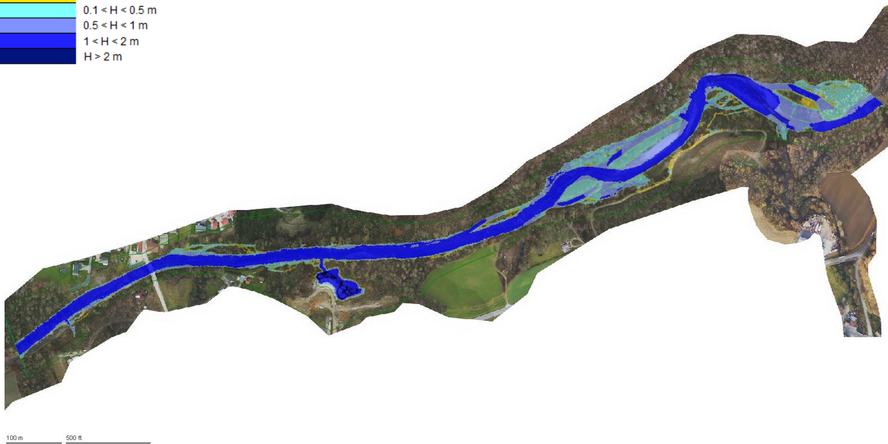
Figure 30 : Cartographie des hauteurs d'eau maximales dans l'état projet pour le débit de pointe biennal Q2
