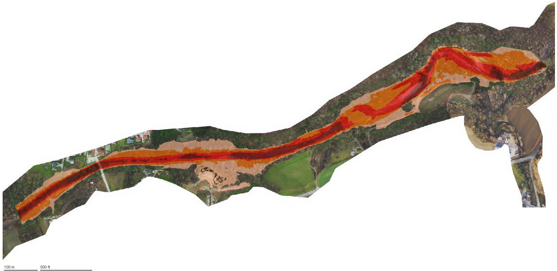
Figure 35: Cartographie des vitesses d'écoulement dans l'état projet pour le débit de pointe centennal Q100
