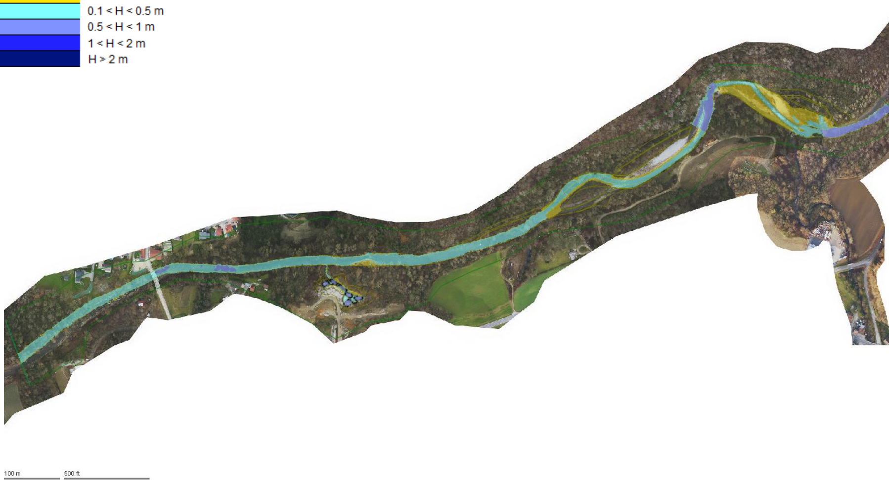
Figure 29: Cartographie des hauteurs d'eau maximales dans l'état projet pour le module
