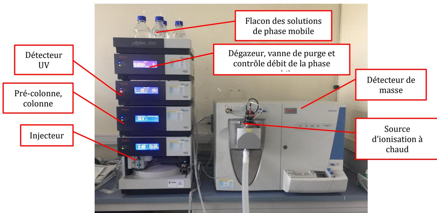
Figure 3 : Appareil analytique UHPLC/MS
