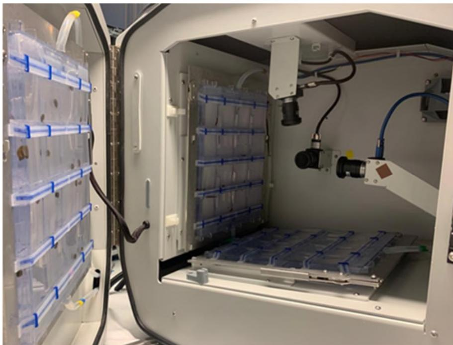
**Figure 4: Photographie de l'analyseur du ToxMate. Sur la porte le panel contenant les Radix, sur la base le panel des Gammarus et au fond à la vertical le panel contenant les Erpobdella.**
