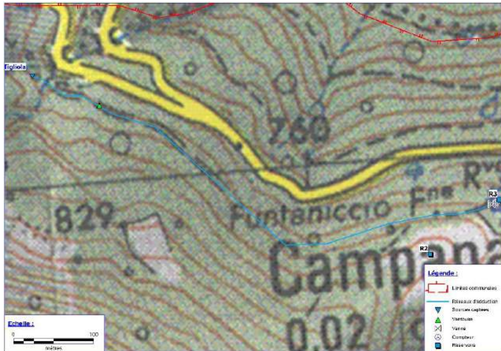
Figure 10 : Tracé du réseau d'adduction de Tigliola et ouvrages (Extrait carte IGN 4349 OT)
