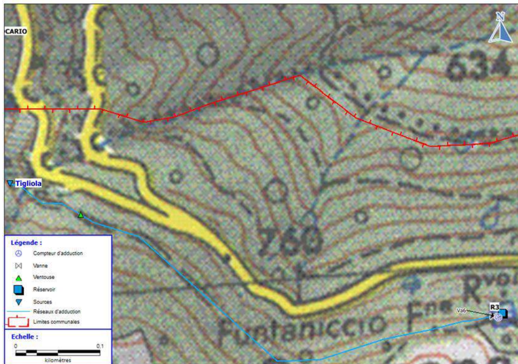
Figure 10 : Tracé du réseau d'adduction de Tigliola et organes (Extrait carte IGN 4349 OT)
